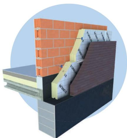
WALL L est un panneau d'isolation thermique en mousse PIR sur deux côtés revêtu d'un complexe multicouche étanche au gaz.
